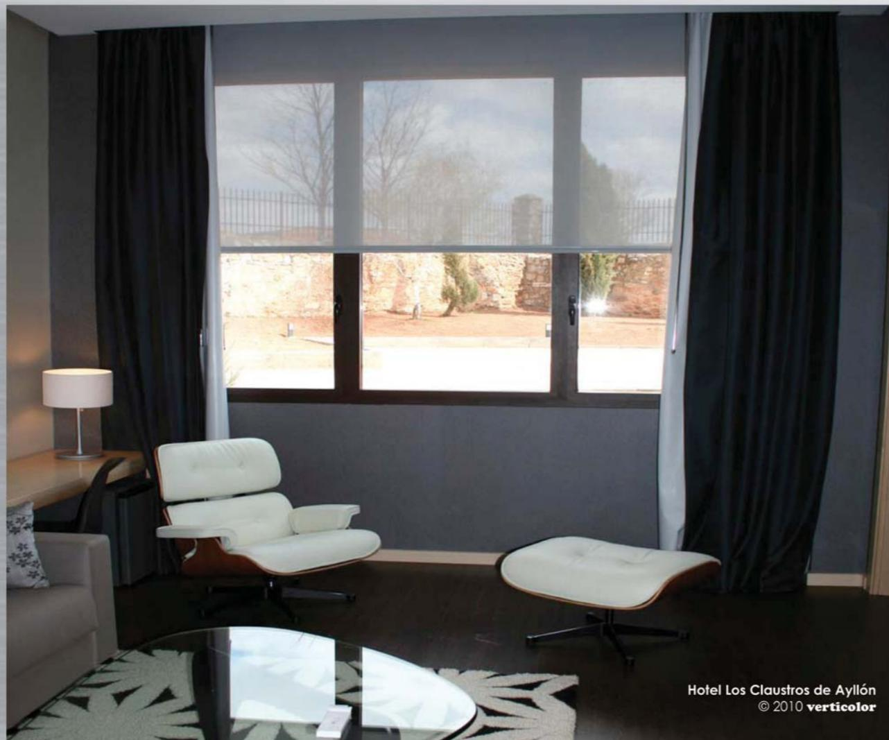
Fabricado a partir de fibras de poliéster y PVC, el **Poliescrin 1400** forma parte de los llamados tejidos técnicos, nos aporta luminosidad al interior de la estancia, nos permite ver el exterior y ofrece protección solar con respecto a los dañinos rayos solares. Clasificación al fuego M-2 de acuerdo con la norma UNE-23727-90. También posee la clasificación B-1 de acuerdo con la norma alemana DIN4102.
